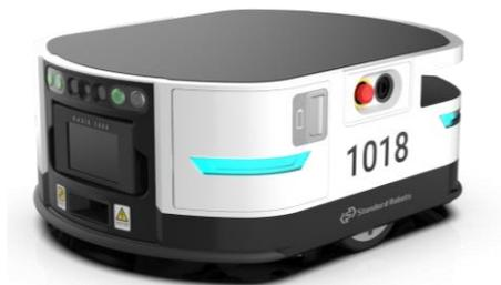
Oasis 180Dは、Standard Robotsの第3世代モバイルロボット技術プラットフォームをベースにした、最大積載量180kgの2輪差動式搬送ロボットです。
